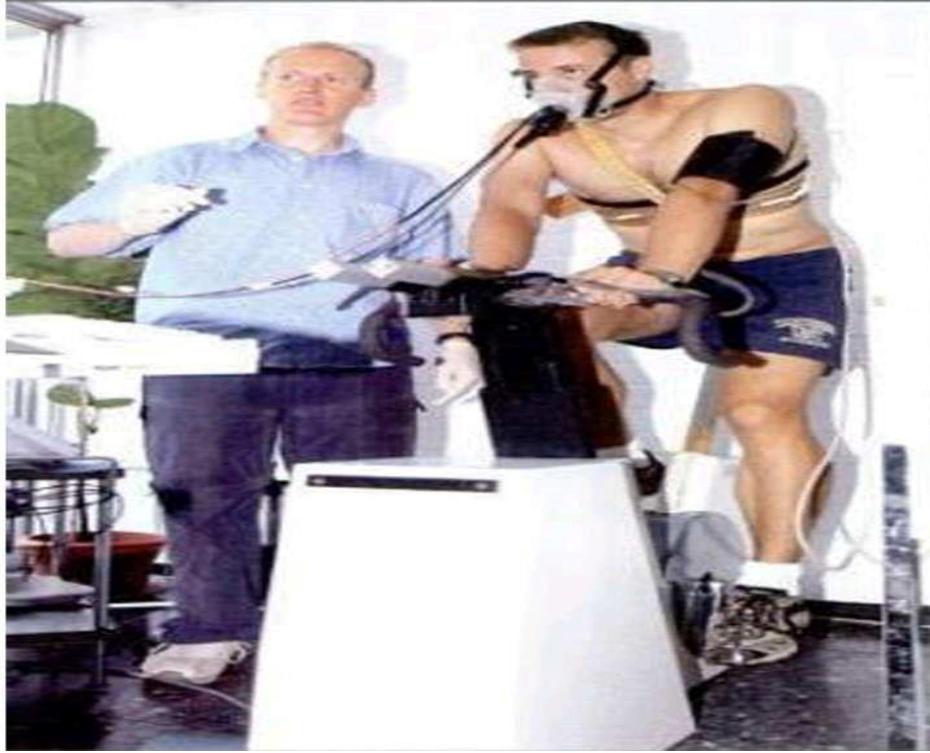
الشكل رقم (03) يوضح اختبار الدراجة الارجومترية لقياس الحد الأقصى لإستهلاك الأوكسجين. المصدر: (منصوري، 2019، صفحة 72).
