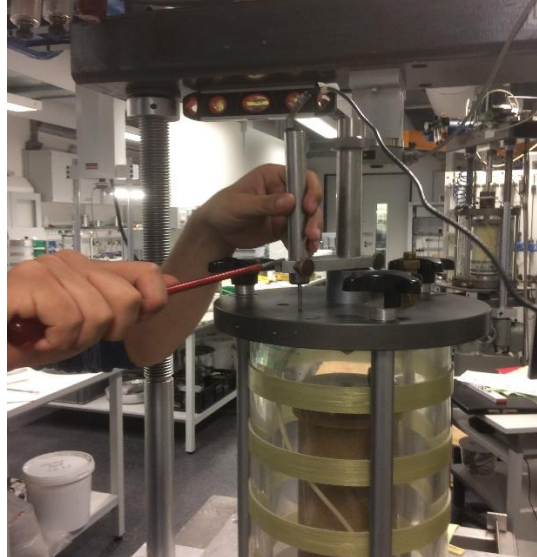
Figure 2.7 : Capteur de déplacement (LDVT)
