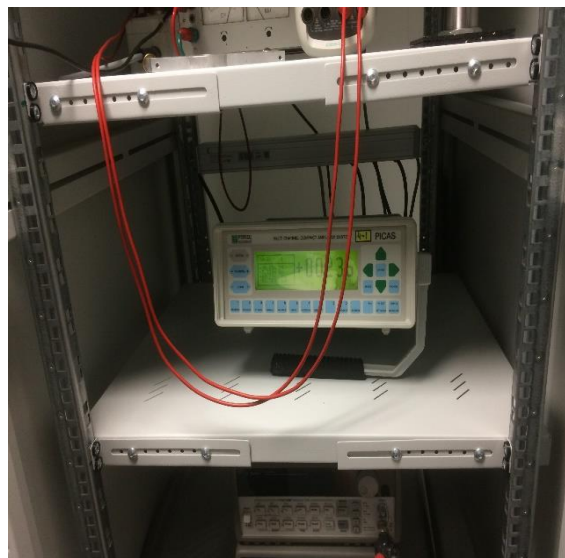
Figure 2.8 : Equipements de l'appareil triaxial (Système multi amplificateur de mesure).
