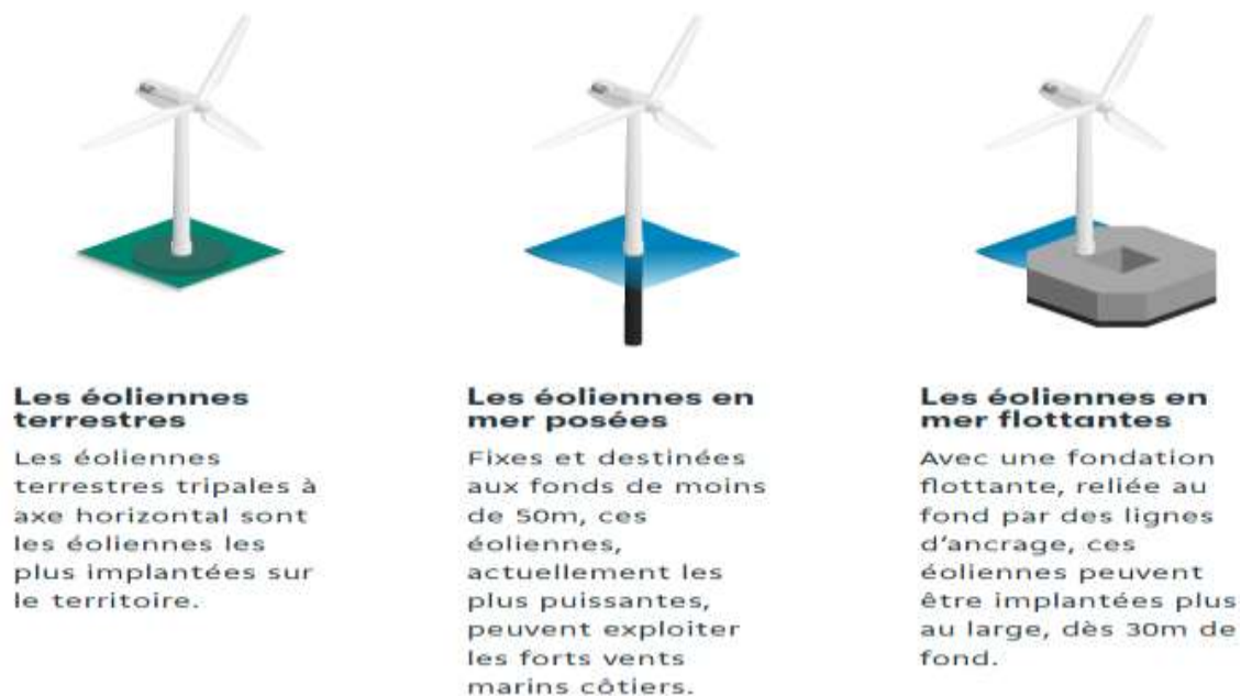
Figure I.8 Eolienne a axe horizontal [14].
