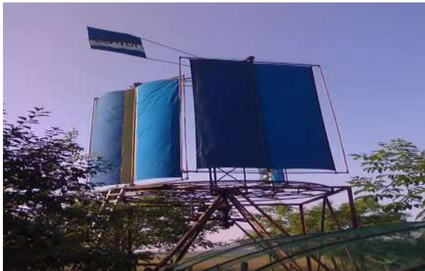
Figure I.7 éolienne à axe vertical et à voile tournante [11].
