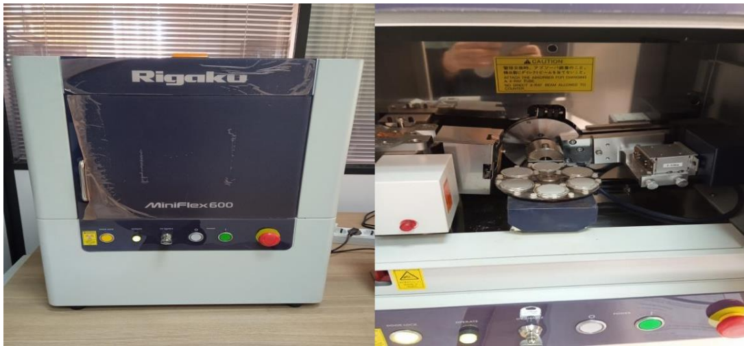
Figure II.10 : Appareil diffraction des rayons X (XRD, Rigaku Miniflex 600).
