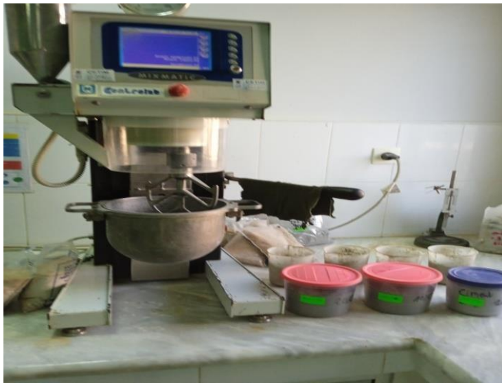
Figure III.10: Préparation des mortiers.
