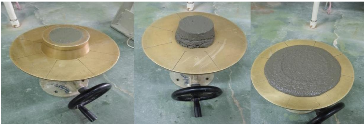
Figure III.11: Etalement du mortier.
