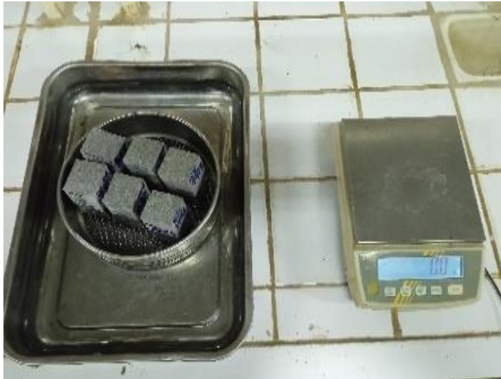
Figure III.13 : Essai d'absorption capillaire.
