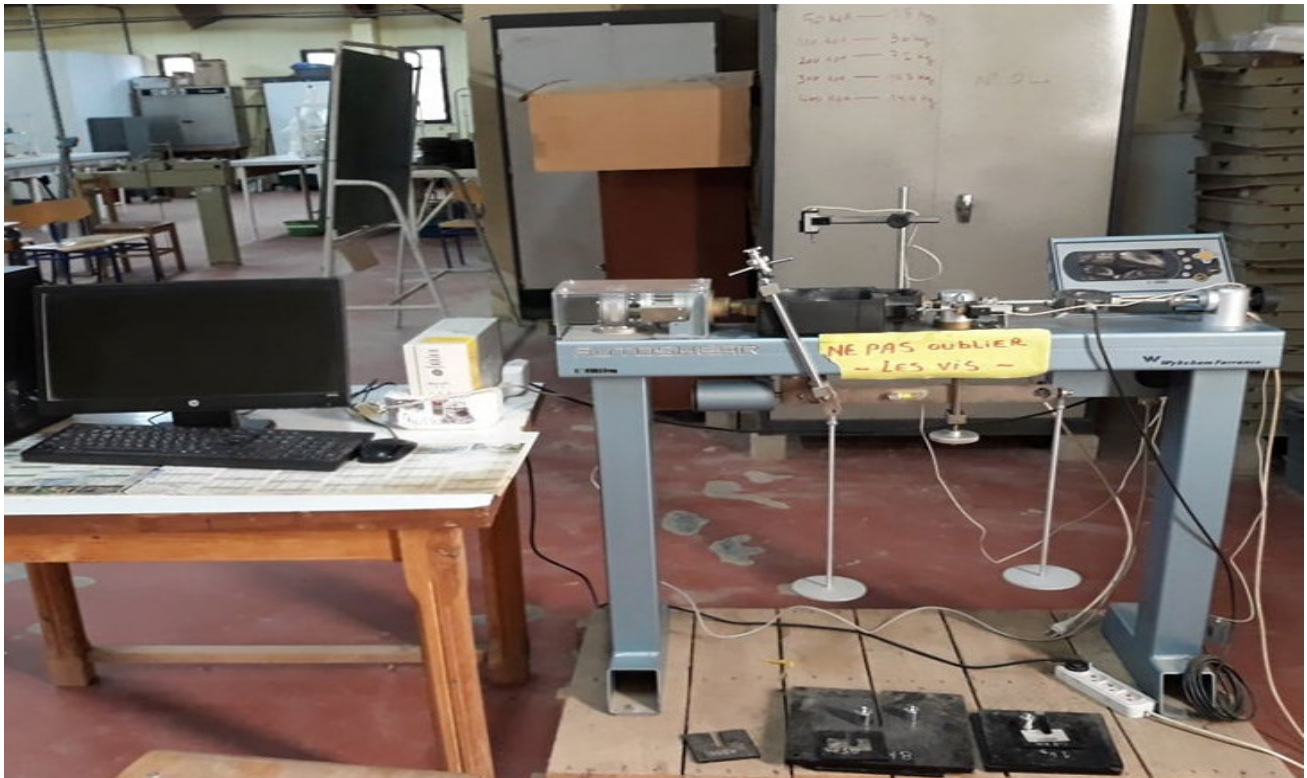
Figure 2.2. Boite de cisaillement utilisée.
