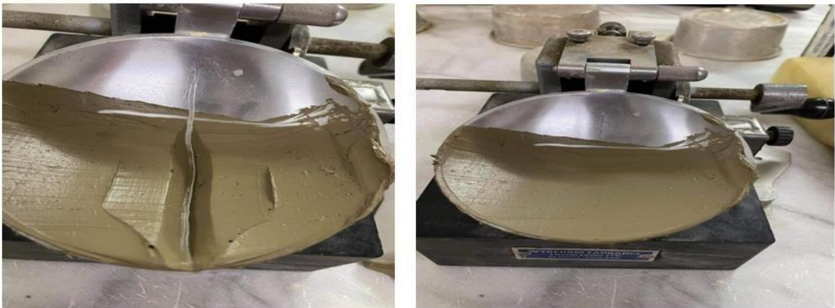
Figure (4.8): L’essai de limite de liquidité W_L .
