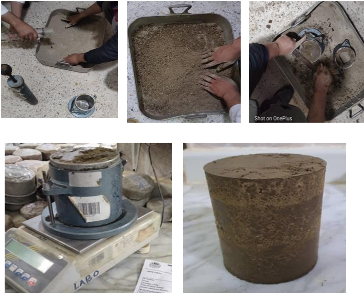
Figure (4.12) : Etapes d'essai de Proctor.
