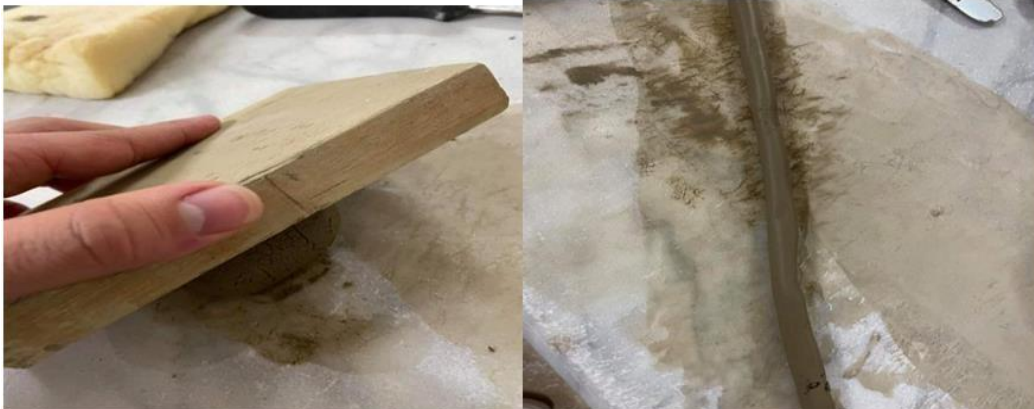
Figure (4.10) : L'essai de la limite de plasticité ( W_p ).
