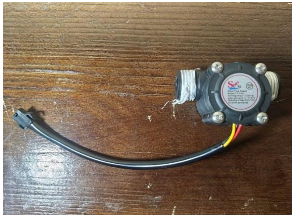
Figure (III.11) : Un capteur de débit d'eau YF-S201.
