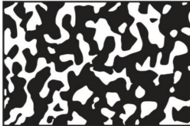
Figure I.15 : Matériau FGM à deux phases avec microstructure squelettique (Hill and Solids 1965).
