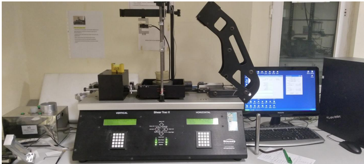
Fig. 2.9 : L'appareil de cisaillement simple cyclique (système Geocomp-ShearTrac II-DSS).
