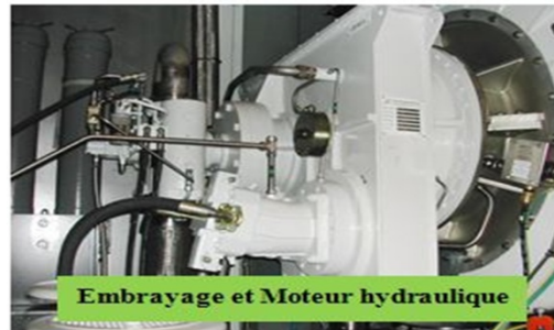
Fig III.10 système de démarrage hydraulique [14] .
