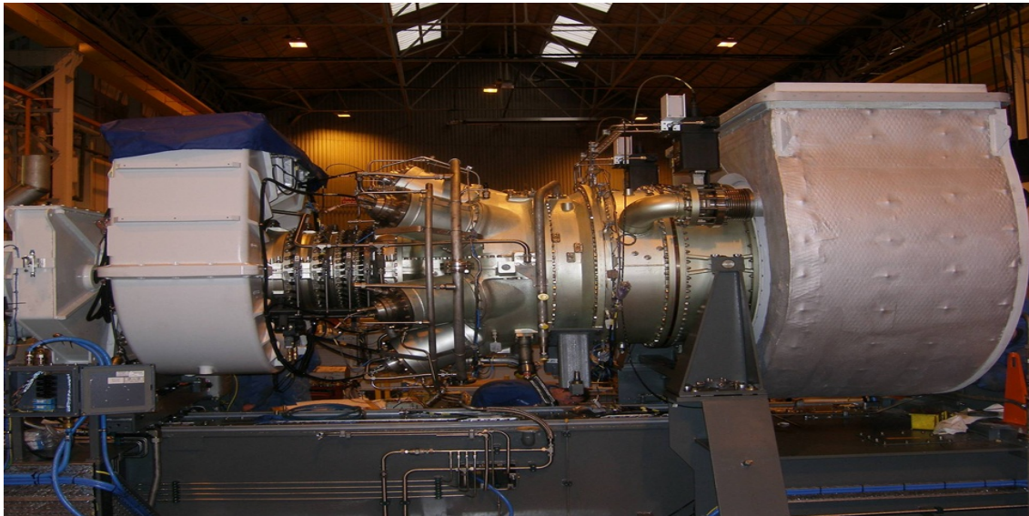
Fig III.1 Turbine à gaz SGT-400 [9] .
