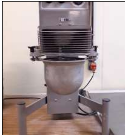
Figure II-4. Malaxeur à mortier.
