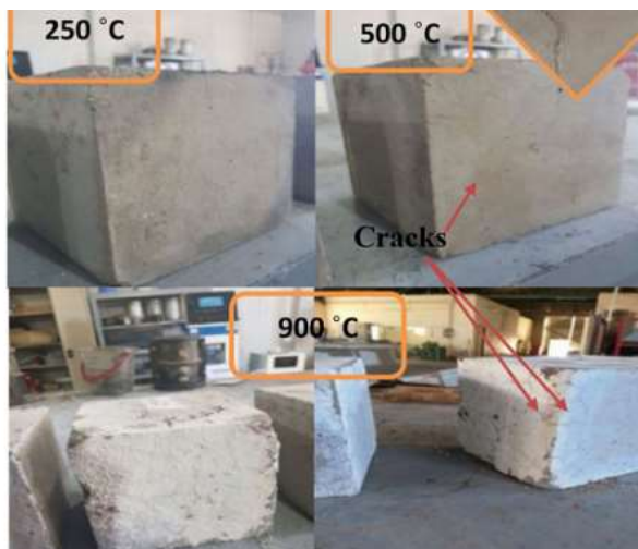
Figure I-42. Différents images de défaillance des éprouvettes de béton incorporant du PV en fonction de la température (Al Saffar, Tawfik et al. 2022)
