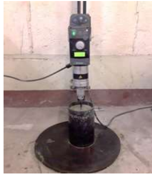
Rhéomètre à mortier
