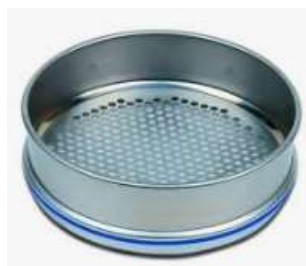
Figure I-6. Essai au Tamis de 5 mm
