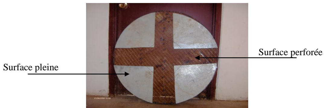
Figure IV.7 : Plancher en forme de x
