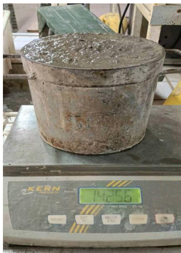
Figure 2. 12. Mesure de la masse volumique à l'état frais.
