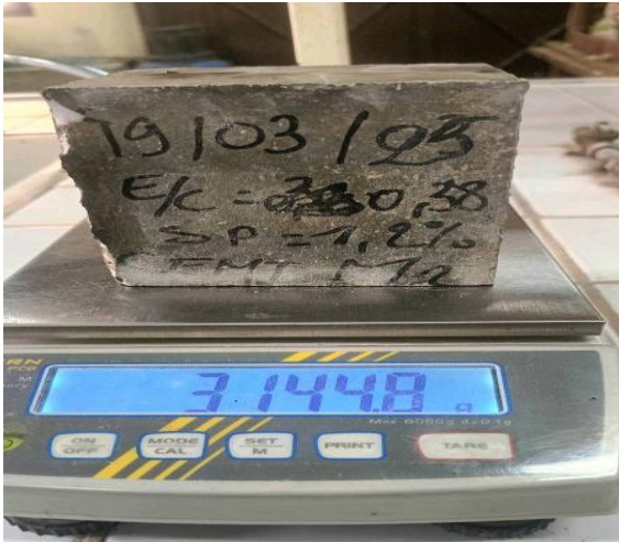
Figure 2. 18. Mesure de la perte de masse.
