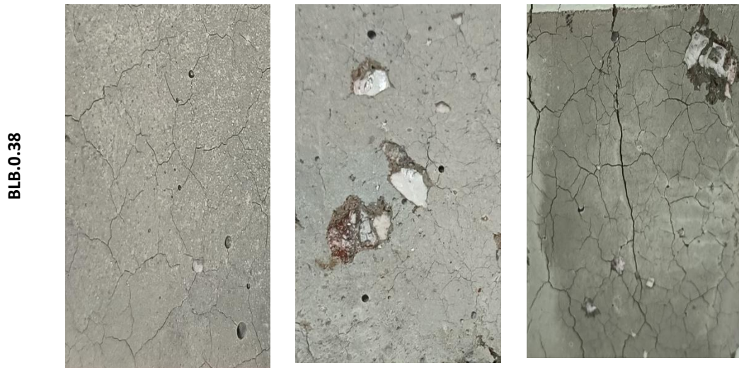
Figure 3. 14. Faciès des bétons lourds (BLB-0.38 et BLB-0.5) soumis à différentes températures.
