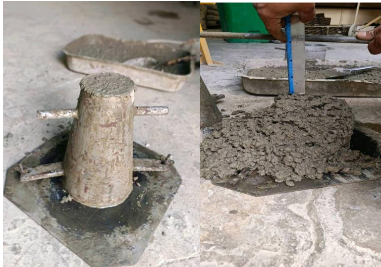
Figure 2. 11. Essai d'affaissement au cône d'Abram.
