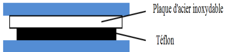
Figure I- 19: appui à glissement (Ounis Hadj, 2014)
