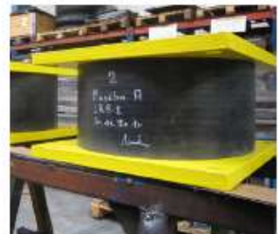
1 Essai sur des appuis LASTO ® LRB 2 Fabrication d'un appui LASTO ® LRB
