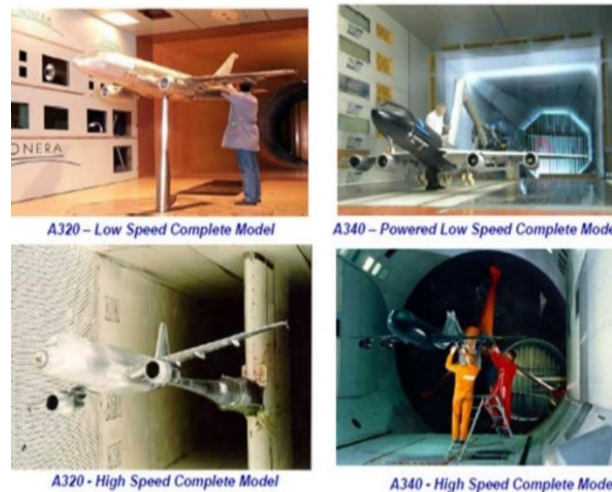
Figure I.6 Exemples tests en soufflerie [5].
