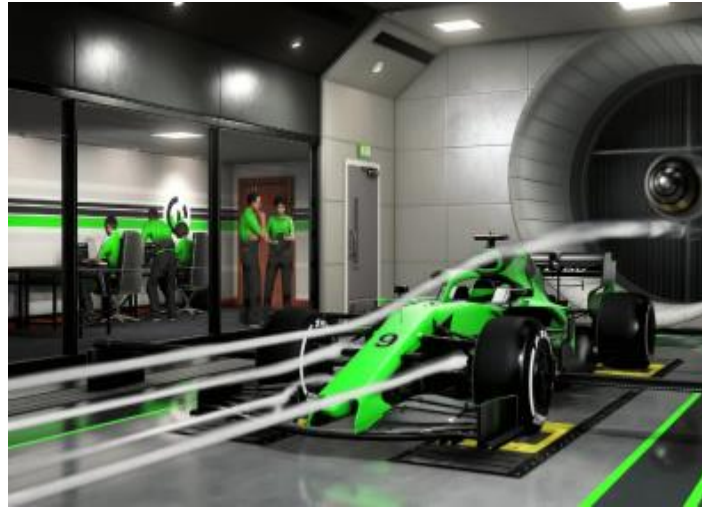
Figure I.3 Test en soufflerie sur un monoplace de type Formule 1 'automobile' [3].
