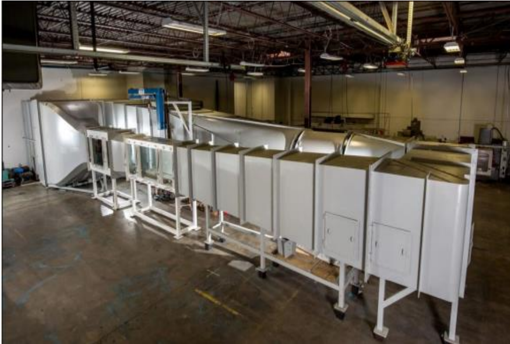
Figure I.2 Modèle de soufflerie à circuit fermé.
