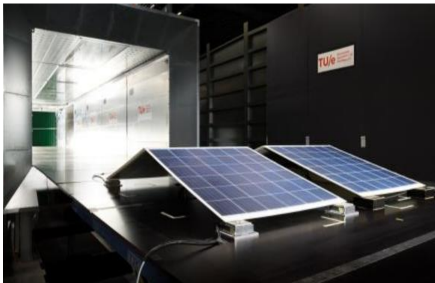
Figure I.4 Étude de l'effet du vent sur des panneaux solaires [3].
