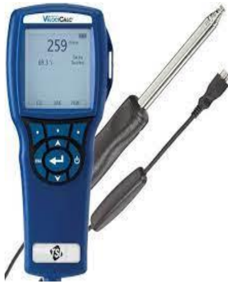
Figure II.5 Appareil multifonction VELOCICALCL 9565.
