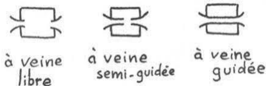
Figure I.10 le schéma des trois types des souffleries [4].
