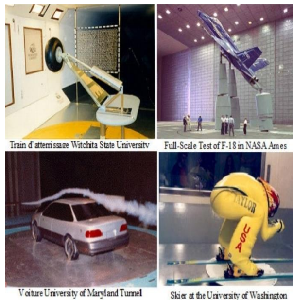
Figure I.5 Exemples tests en soufflerie [4].
