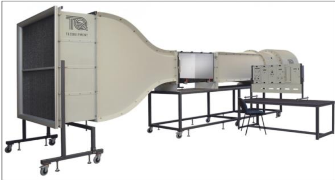
Figure I.1 Modèle de soufflerie à circuit ouvert.
