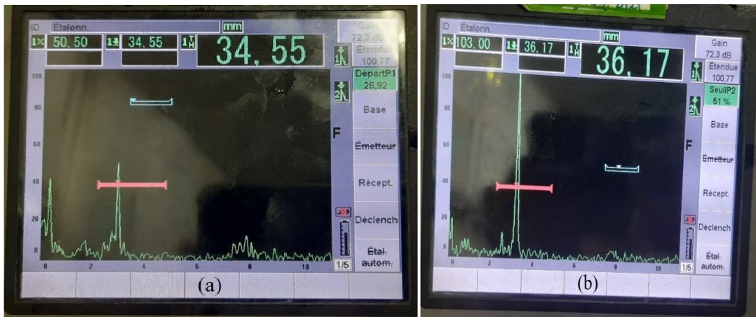
Figure III.13: Contrôle par ultrason de la condition(A), (a) avec bourrelet et(b)sans bourrelet
