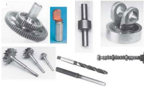
Figure I.6: Pièces soudées par friction rotative [8]
