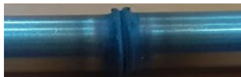
Figure II.4. Profil d'un joint de soudure par friction
