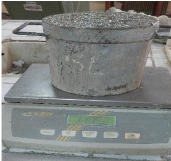
Figure 3. 8. Mesure de la masse volumique du BHP frais.
