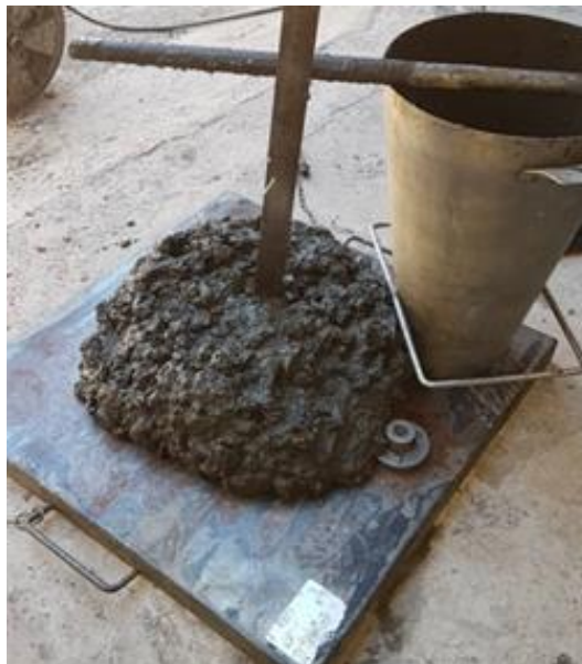
Figure 3. 7. Essai d'affaissement au cône d'Abrams.
