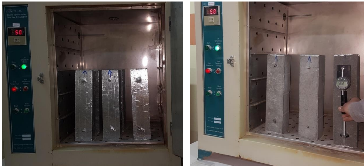
Figure 3. 14. Mesure des retraits endogène et total à 20 °C, 35 °C et 50 °C.
