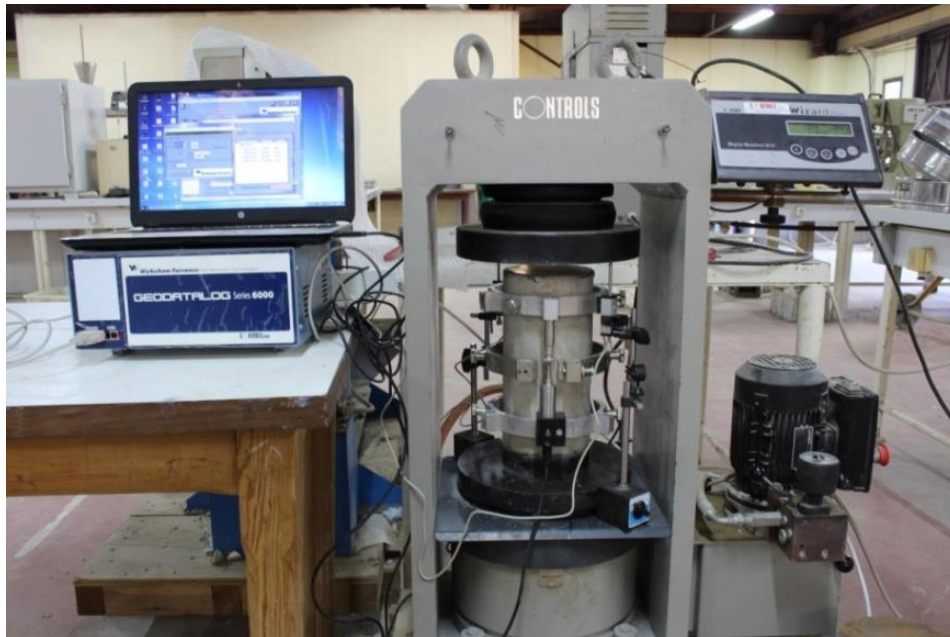
Figure 3. 9. Dispositif de mesure du module d'élasticité.
