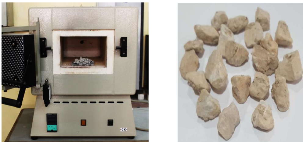
Figure 3. 4. Décollement du mortier attaché par traitement thermique.
