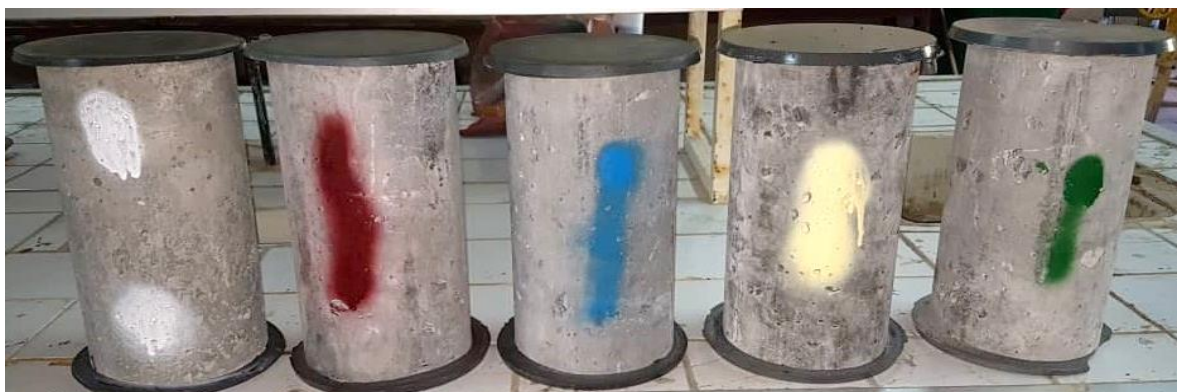
Figure 3. 10. Surfaçage au soufre des éprouvettes cylindriques.
