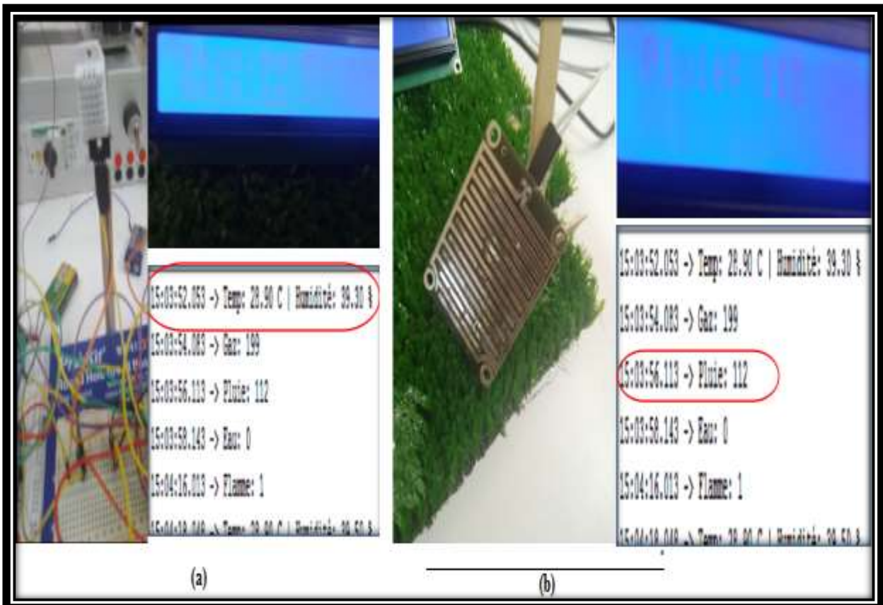
Figure (IV.21) : (a) Affichage les valeurs (a) Humidité et température (b) pluie sur serial monitor et afficher LCD
