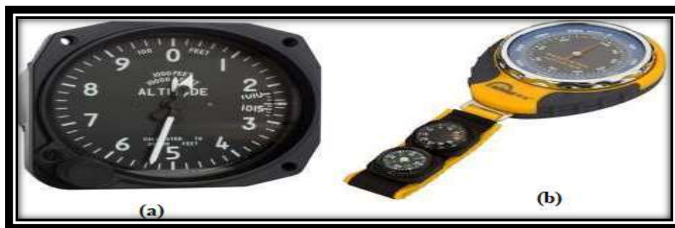
Figure (I.12) : Instruments de mesure de l'altitude : (a) l'altimètre, (b) l'altimètre barométrique
