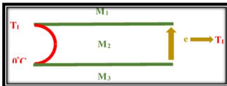
Figure (II.4) : Exemple d'un Effet thermoélectrique (principe du thermocouple).
