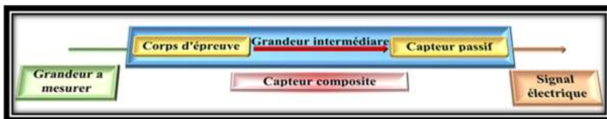
Figure (II.2) : Schéma d'un capteur composite
