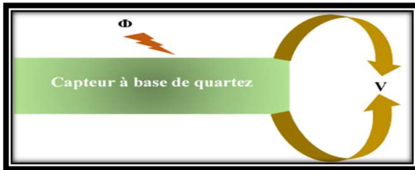
Figure (II.7) : Principe d'un Effet pyroélectrique
