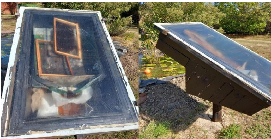
Figure II.3 Cérificateur solaire contenant un cadre de cire de corps. [11]
