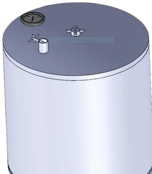
Figure III.23 Montage du capteur thermique
