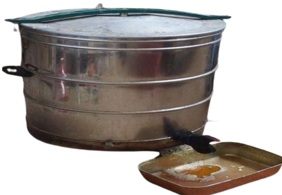
Figure II.6 Ecoulement de la cire fondue de la chaudière à vapeur.
