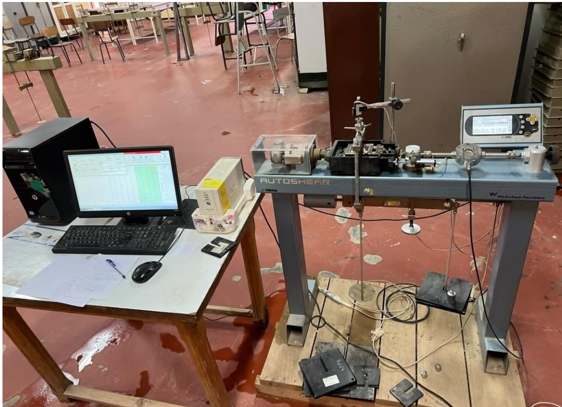
Figure 2.5 : Appareil de cisaillement direct utilisé (laboratoire de mécanique des sols de l'université Hassiba Benbouali de Chlef, Algérie).
