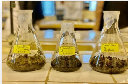
Figure IV.9 : Extraction par macération classique
