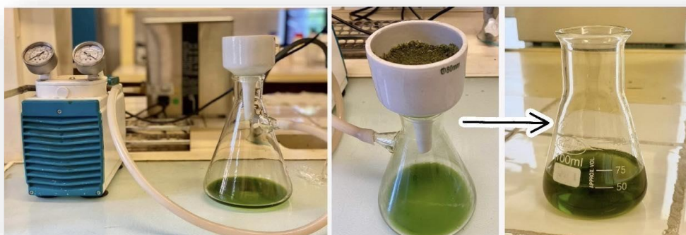
Figure IV.12 : La filtration sous vide
