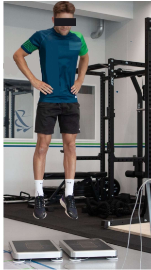
Figure 39 : Posture initiale avant d'effectuer un CMJ sur la plateforme de Force Kistler.
