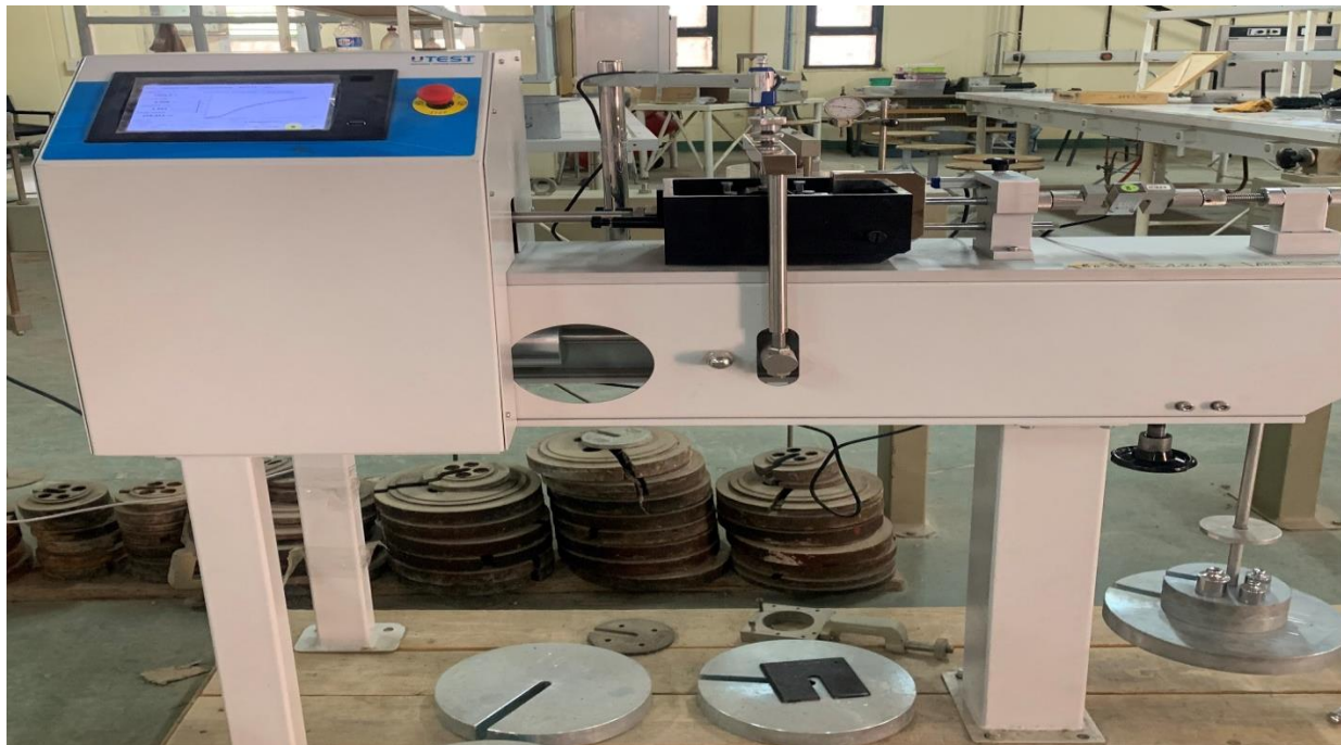
Figure 2.1 : Machine de cisaillement direct à la boîte de casagrande .(laboratoire de mécanique des sols de l'université Hassiba Ben Bouali de Chlef, Algérie)
