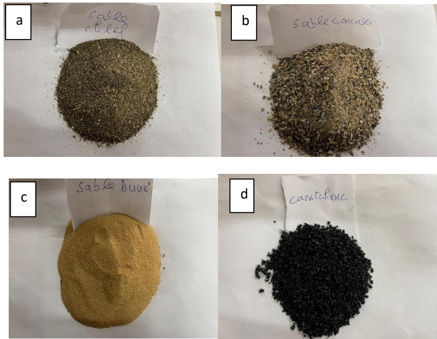
Figure 2.5 : Les matériaux utilisés dans cette étude expérimental a) sable chlef b) sable concasser c) sable dune d) granulat de caoutchouc.
