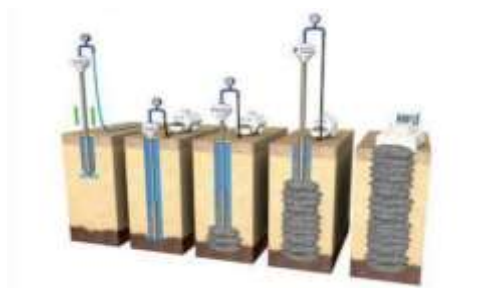
Fig. 1.7. Schéma de réalisation de colonnes ballastées ( http://lycee-cherioux.fr/ )
