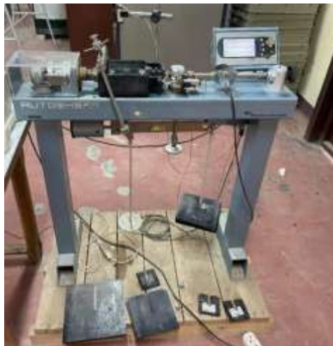
Fig. 2.8. L'appareil de cisaillement de laboratoire université Chlef
