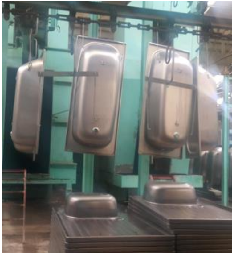
Figure I. 22 Ligne de nettoyage des baignoires.
