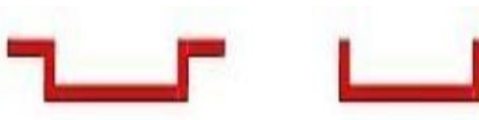
Figure I. 6 Étape n°5 : Le détourage de la pièce emboutie.
