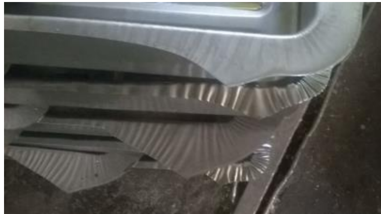
Figure I. 26 Défaits de plissement dans le procédé d'emboutissage.
