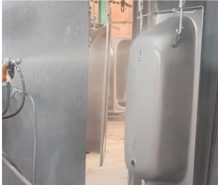
Figure I. 23 Ligne d'enduction massive.
