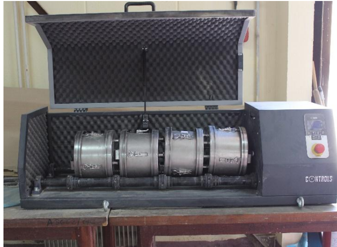
Figure 3. 1 : Broyage du kaolin dans la machine de Micro-Deval.
