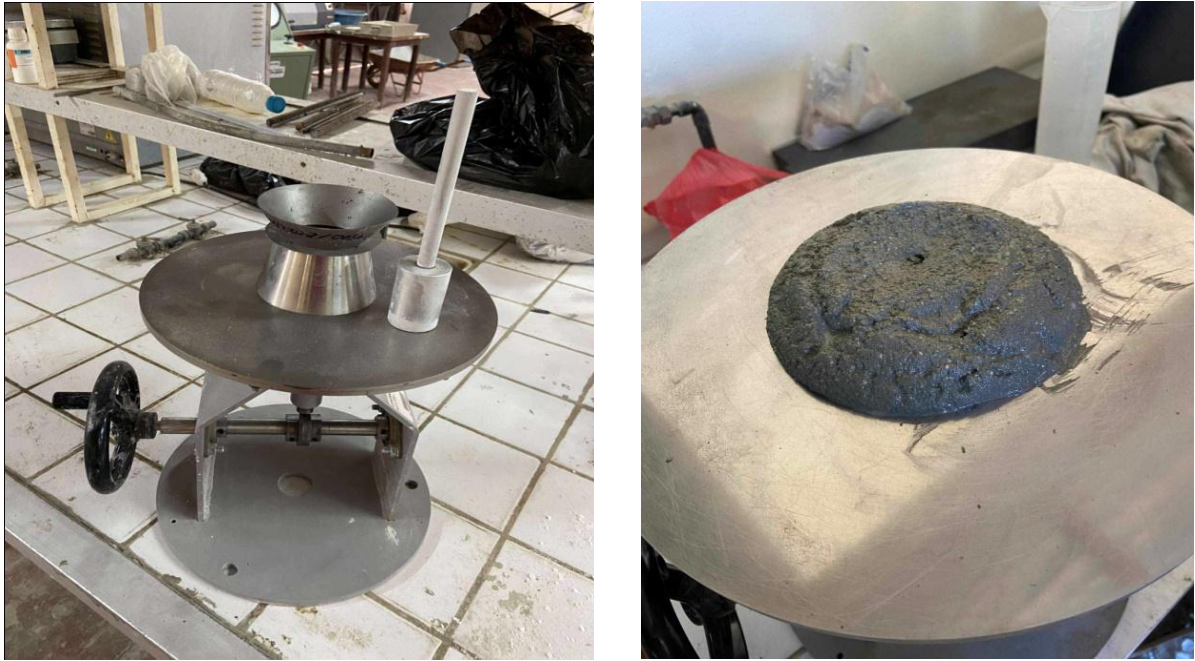
Figure 3. 9 : Mesure de l'étalement pour les mortiers à l'état frais.
