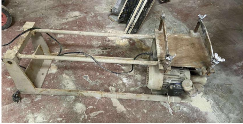
Figure 3. 6 : Serrage des éprouvettes avec la table à choc.
