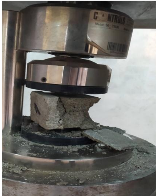
Figure 3. 11 : Essai de compression sur demi-prismes.
