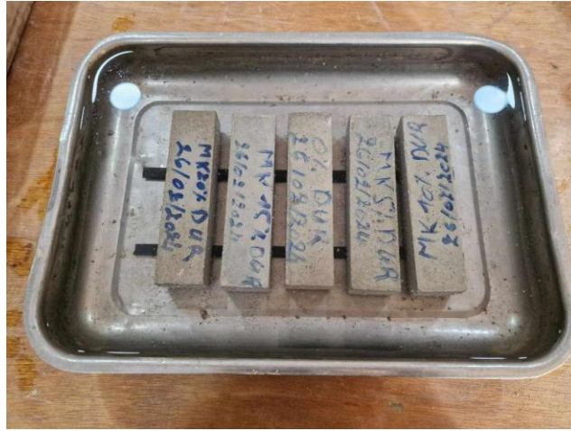
Figure 3. 13 : Essai d'absorption d'eau par immersion.
