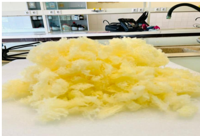
Figure II.3 : Luffa après traitement à l'eau de javel.
