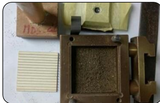
Figure 3.13 : Exemple d'échantillon préparé par la technique de damage humide
