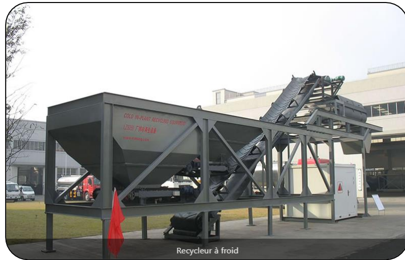
Figure 2.9 : Recyclage de l'asphalte à froid (D'après : metongfrench)
