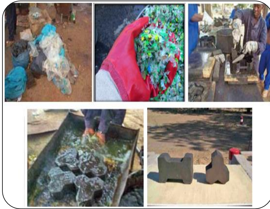
Figure 2.7 : Phases de la confection des pavés de sol (Gilles et Sorgho, 2009).
