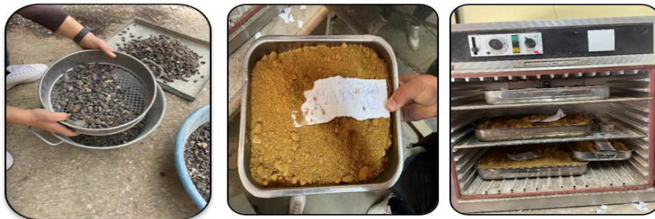
Figure 3.2 : Préparation des matériaux.
