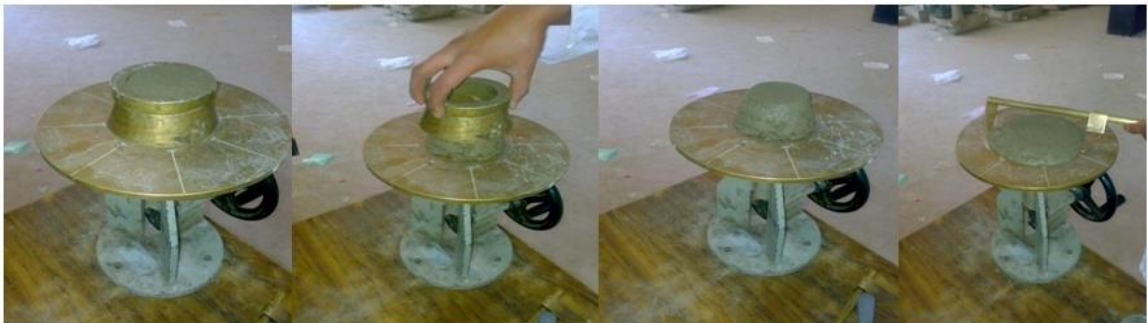
Figure 3.4: Les démarches de l'essai d'ouvrabilité par la table à secousse.
