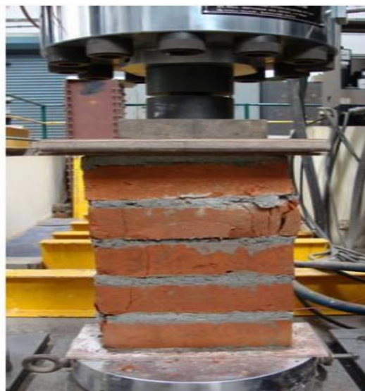
Figure 2.16: Teste de compression de maçonneries [107].
