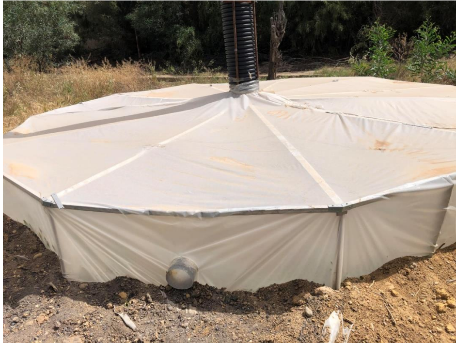
Figure IV.9. Photo des ouvertures d'entrée de l'air dans le collecteur
