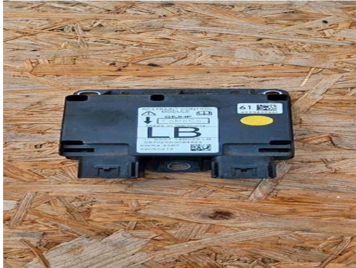
Figure 1.46 : Calculateur de coussins gonflables
