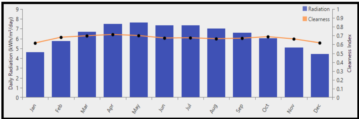
Figure 2.2 : Évolution de l'ensoleillement mensuelle superposé à l'indice de clarté.
