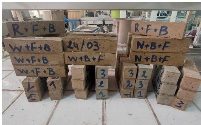
Figure 3.13. Épreuves de mortiers.
