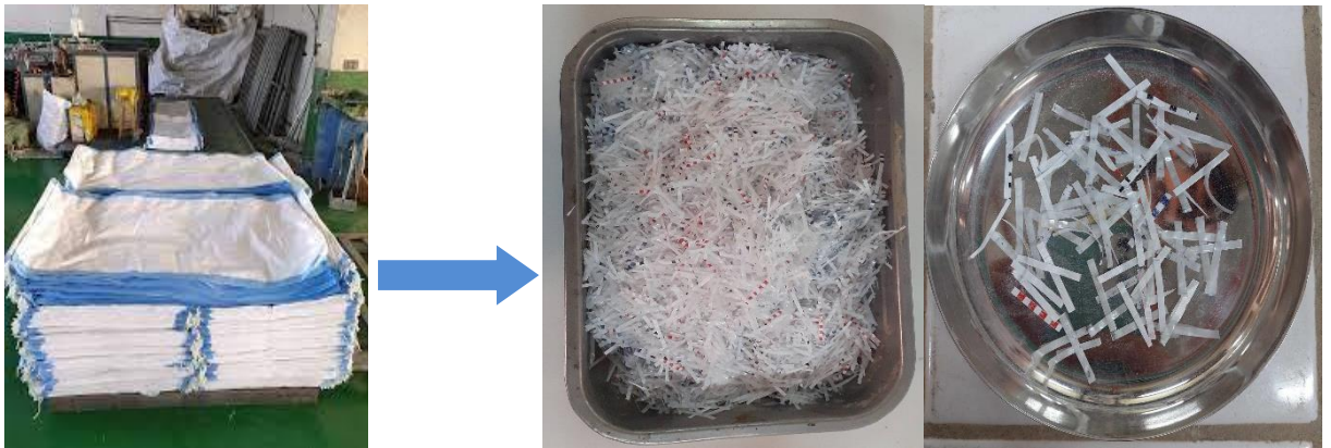
Figure 3.6. Processus de production des fibres de polypropylène.
