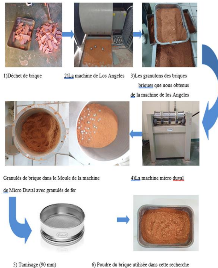
Figure 3. 3. Processus de production de la poudre du brique.
