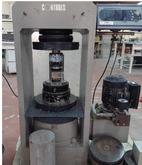
Figure 3.15. Essai du dispositif de compression simple.
