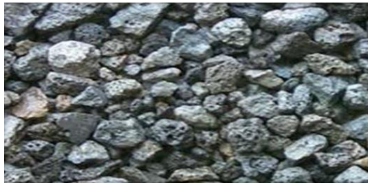
Figure 1. 6. Bloc de laitier de haut fourneau.
