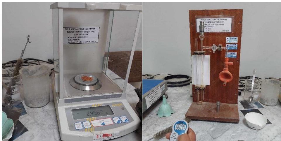
Figure 3. 5. Essai de mesure de la finesse de la poudre de brique .
