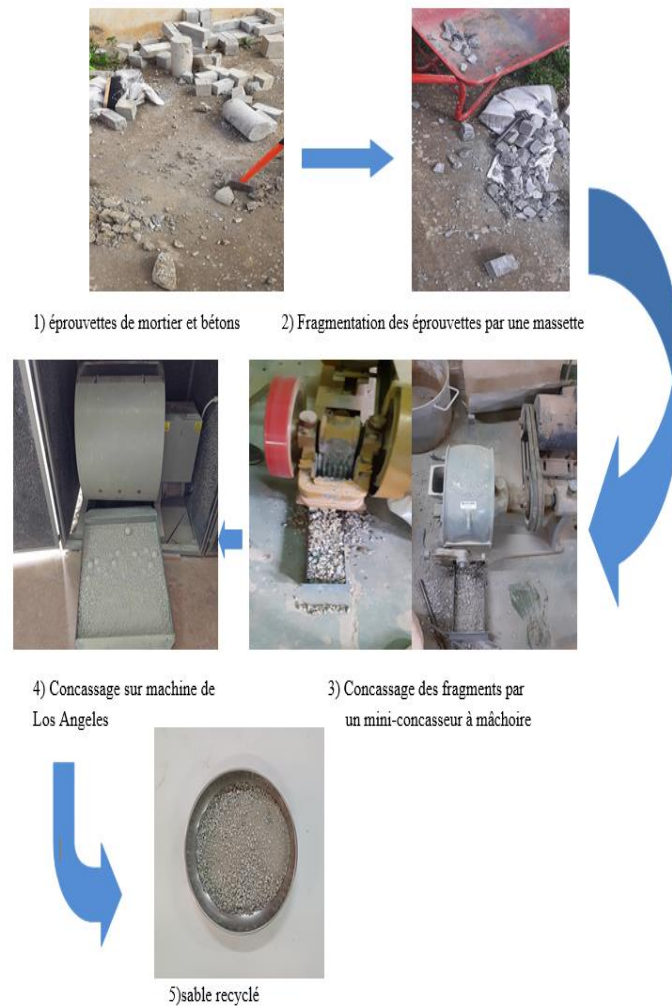
Figure 3. 2. Processus de production du sable recyclé.
