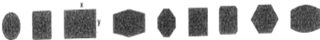
Figure 1.9 : Formes favorables, plans simples ayant au moins 2 axes de symétrie.
