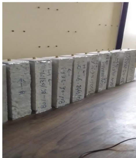
Figure 3.11. Conservation des éprouvettes au laboratoire a 20°C.
