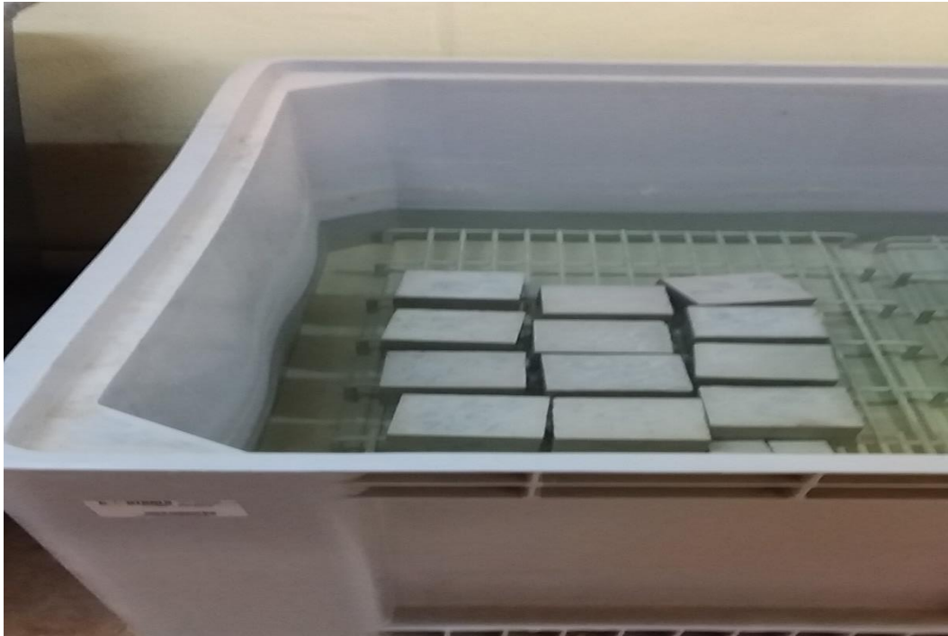
Figure 3.13. Mode d'immersion des éprouvettes pour la mesure d'absorption.
