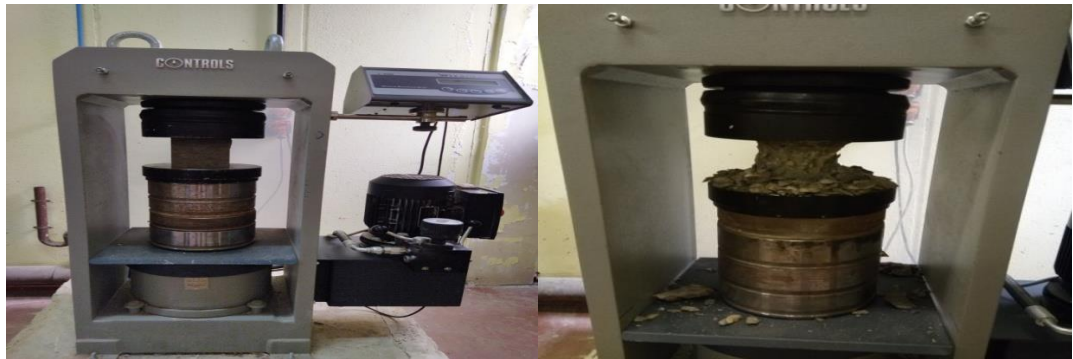
Figure 3.9. Cube en béton soumis à un essai de compression à l'aide d'une presse hydraulique.
