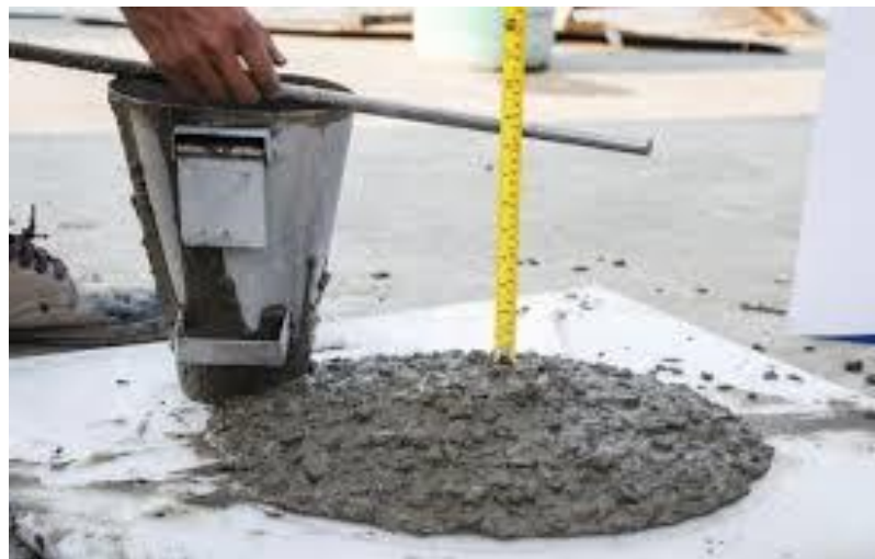
Figure 3.8. Mesure d'affaissement par le cône d'Abrams.
