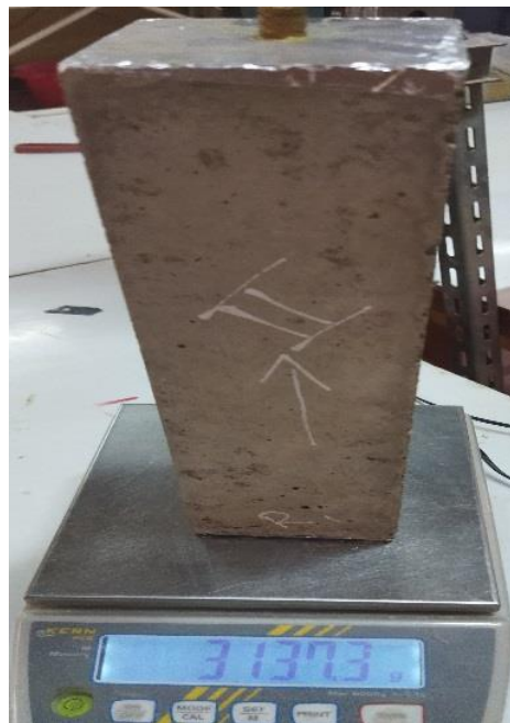
Figure 3.15. Suivi du poids d'une éprouvette séchant à l'air libre (perte en poids).
