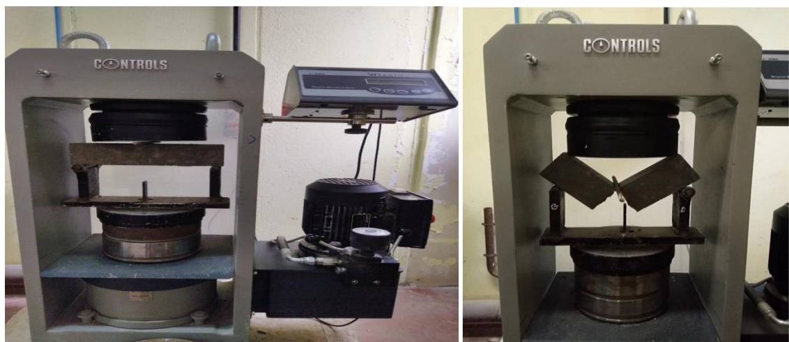
Figure 3.10. Prisme en béton soumis à un essai de compression à l'aide d'une presse hydraulique.
