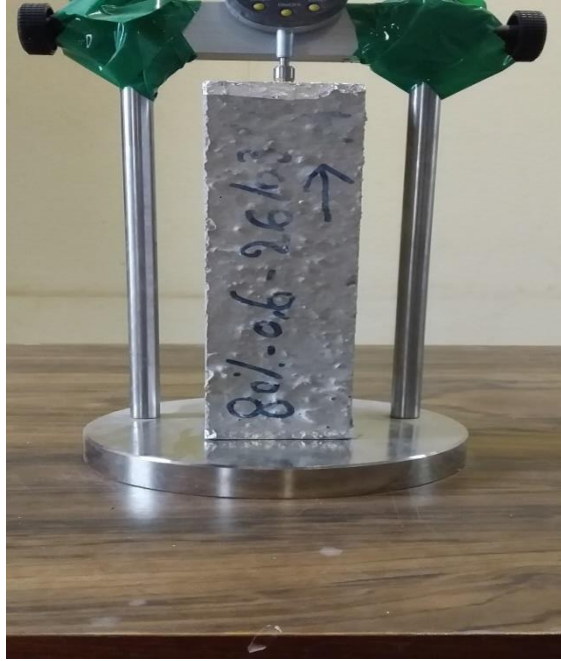
Figure 3.12. Bâti de mesure du retrait avec un comparateur d'une précision de 1 \mu\text{m} .
