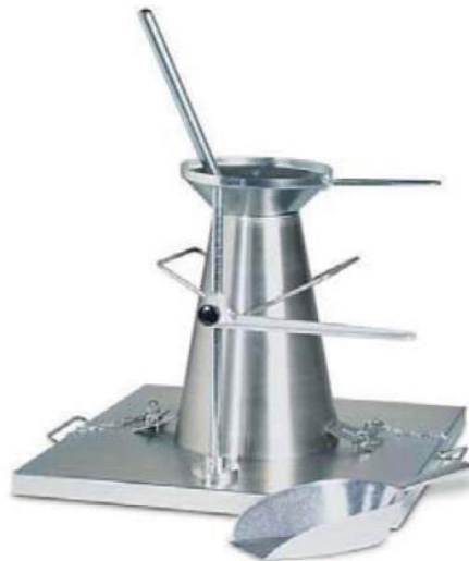
Figure 3.6. Cône d'Abrams utilisé pour mesurer l'affaissement
